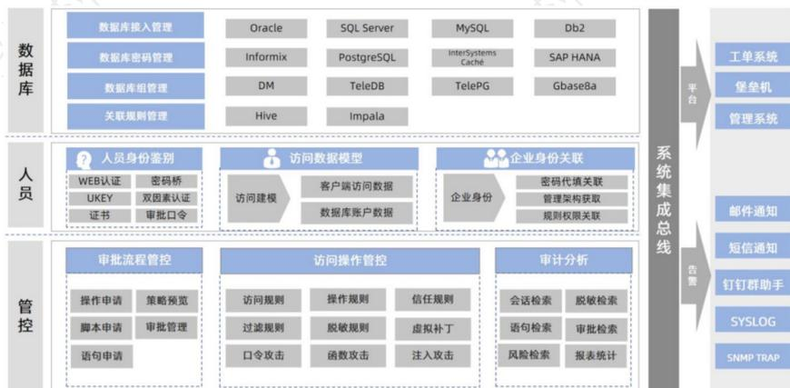
图 B-9 数据库运维安全系统架构图
