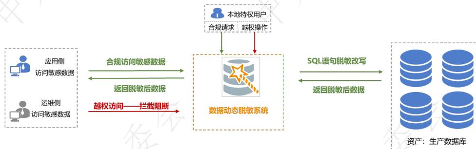
图 B-10 数据动态脱敏框架示意图
