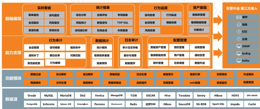
图 B-20 数据库审计系统框架图
